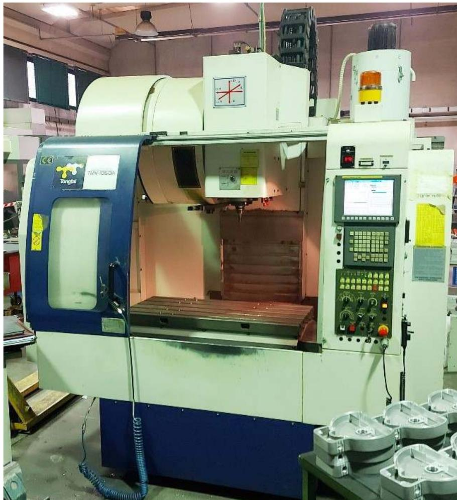
CNC: FANUC OiMC con Manual Guide e volantino elettronico remotato
