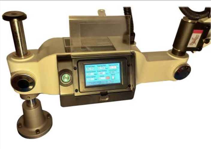
Robusta struttura in fusione che incorpora l'azionamento e l'unità di comando
