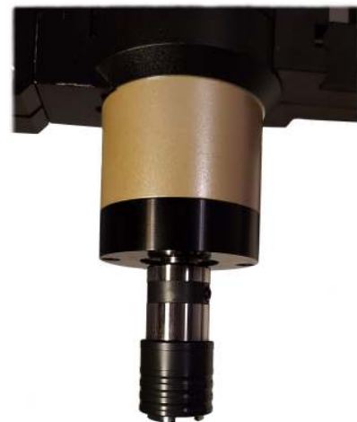
Riduttore epicicloidale di precisione e mandrino con pinza a presa rapida
