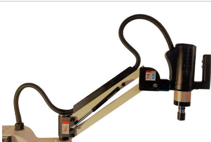
Braccio articolato con doppio cilindro compensatore e canalina per passaggio cavo
