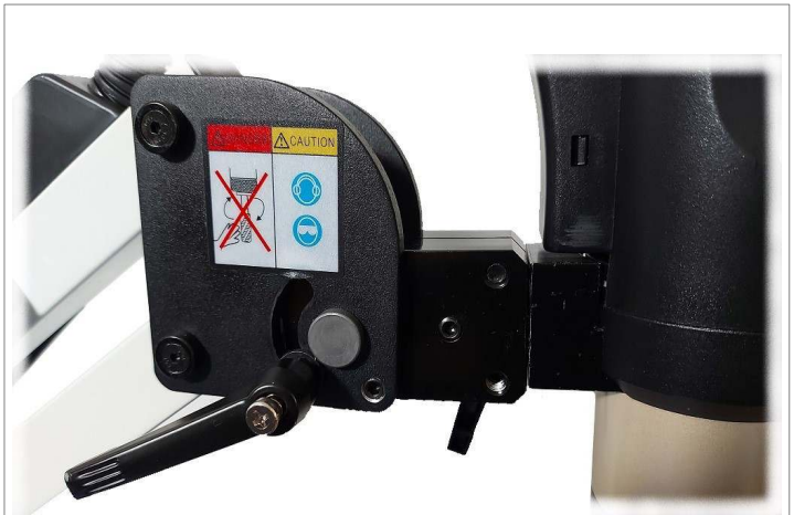
Piastra portatesta regolabile per l'orientamento su differenti piani di lavoro
